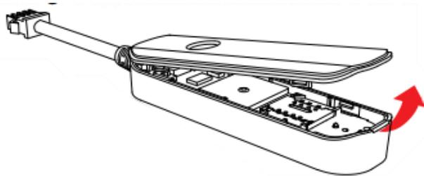
Em seguida ao visualizar o slot, empurre-o para trás, levante-o e coloque o chip;
